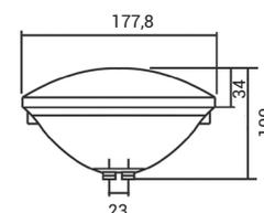
Ampoules (dimensions en mm)
